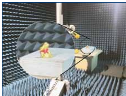
UHF RFID-Tag auf Metall funktioniert – wenn man die Position mit Bedacht wählt.
